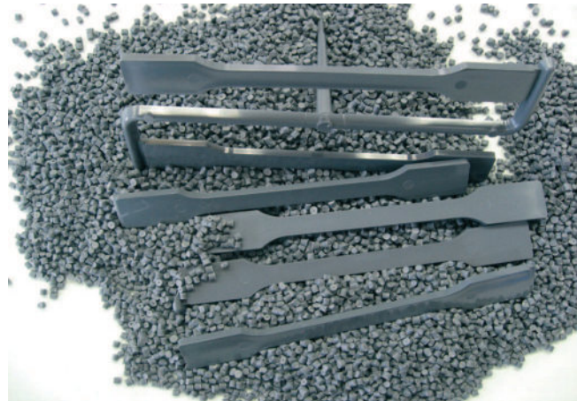
Kunststoffgranulat und Prüfkörper aus sortenreinem Kunststoffmahlgut
