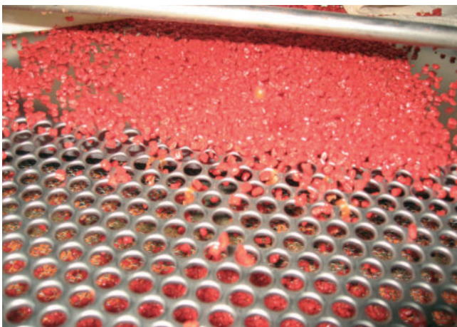
Eingefärbtes Granulat aus glasklarem Mahlgut
